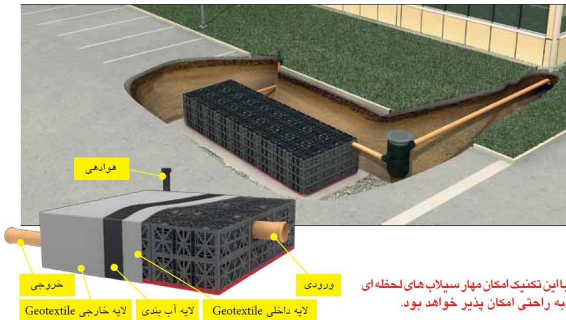
شکل ۵: ساختار سیستم تونلی گراف
