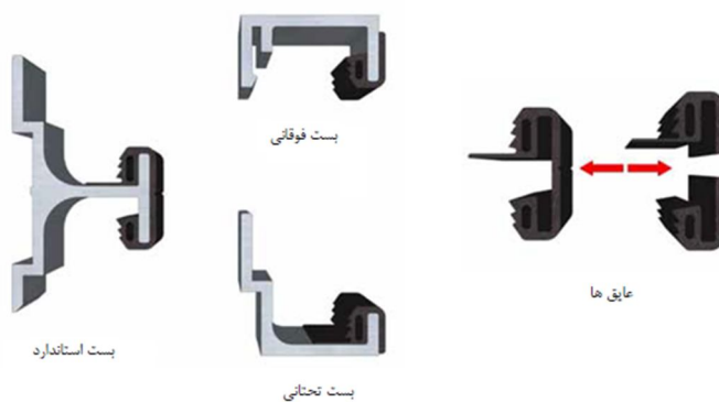
شکل ۷-۱۱- نصب درزپوش بر روی بست‌ها
