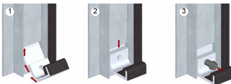
شکل ۷-۱۲- نحوه نصب بست‌ها بر روی ریل
